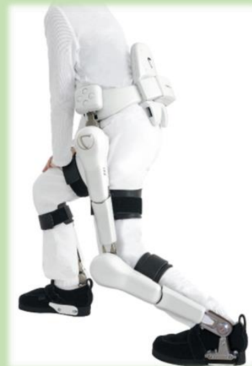
介護リハビリロボットHAL 筑波大学／サイバーダイナミクス社
