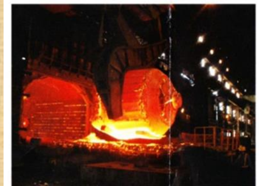
世界最大の鋼塊 (600トン)
